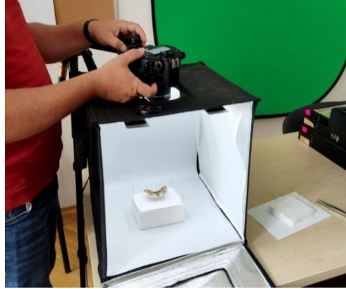
Рис. 1. Фотосистема на базі Canon EOS 800D, що використовується для оцифрування ентомологічних зразків (фото А.Г. Савицької).
